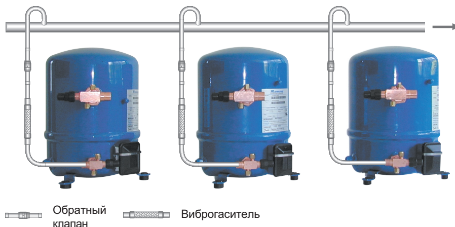
Рис. 3.7. Схема нагнетательного коллектора при его размещении выше уровня нагнетательных патрубков.
