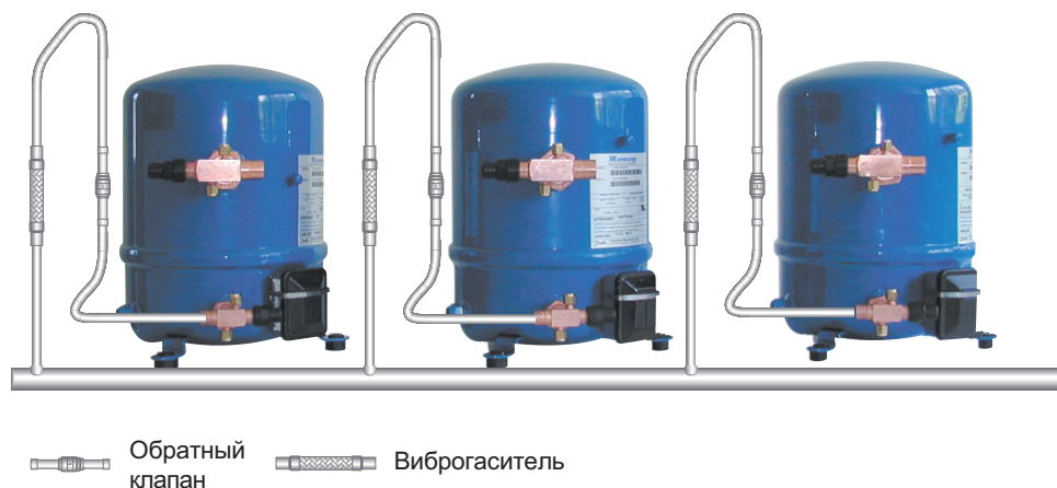
Рис.3.6. Схема нагнетательного коллектора при его размещении ниже уровня нагнетательных патрубков.
