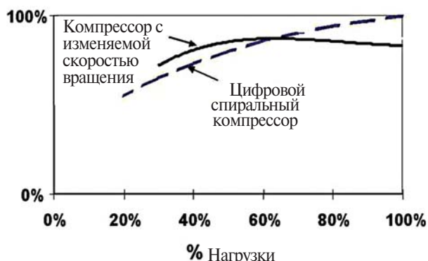
Рис.17. Типовые изменения холодильного коэффициента для цифрового и с переменной скоростью спиральных компрессоров при постоянных рабочих условиях
